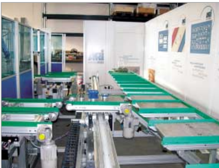
Vista interna con la navetta e gli scambiatori
