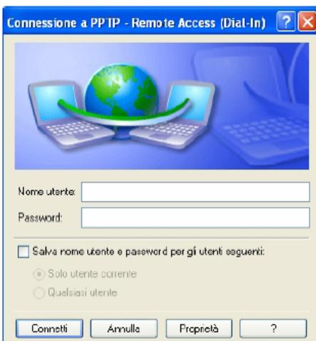
Verrà quindi creata sul desktop un'icona che permette di lanciare la connessione PPTP verso il router A02-RA3, cliccare sull'icona. Inserire **Nome Utente** e **Password** precedentemente impostati nella configurazione VPN PPTP del router e cliccare su **Connetti**. Ora il PC è all'interno della LAN aziendale.
