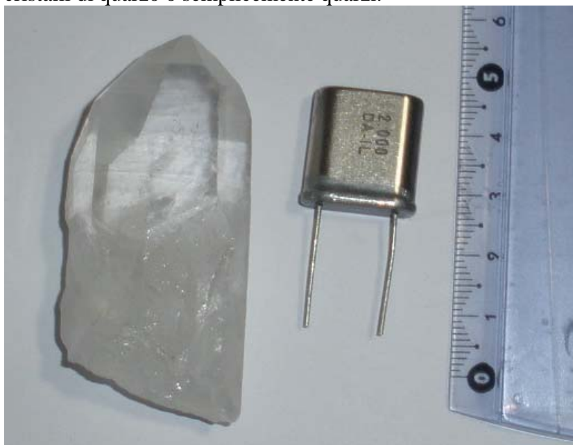
Fig. 18 – Il quarzo come minerale e come componente elettronico
