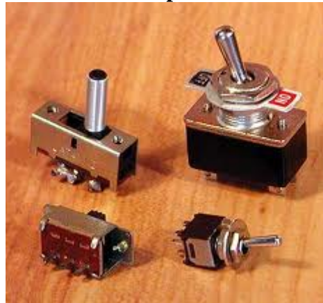
Fig. 4 Simbolo grafico deviatore e vari tipi di deviatori per l'elettronica
