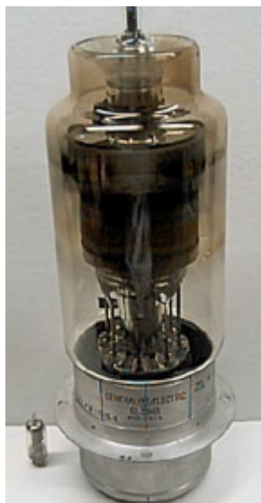
Fig. 1 Un gigantesco thyratron ad idrogeno di produzione GE affiancato ad un più modesto thyratron 2D21 utilizzato come pilota di relais nei juke-box (fonte Wikipedia)
