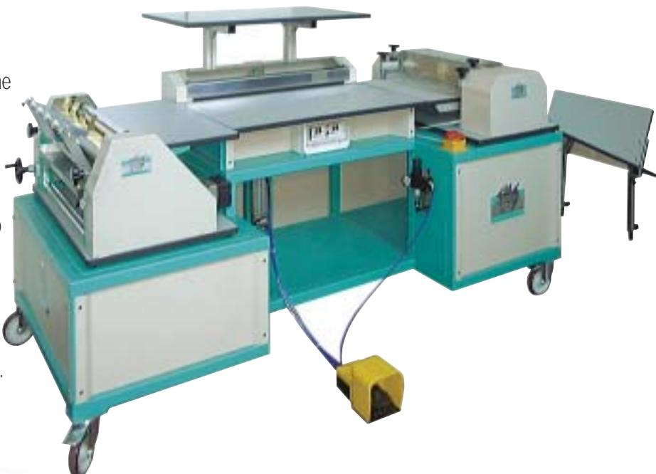
Mordazas de presión en acero revestidas de material plástico para una limpieza más rápida. Estructura de carpintería pesada: resistencia y fiabilidad para el empleo en producción. Disponibles versiones con funcionamiento a pedal y neumático. Sobre pedido, dispositivo para el ciclo automático (versión neumática) para regular la duración de la presión sobre el material; versiones de tamaño especial.
