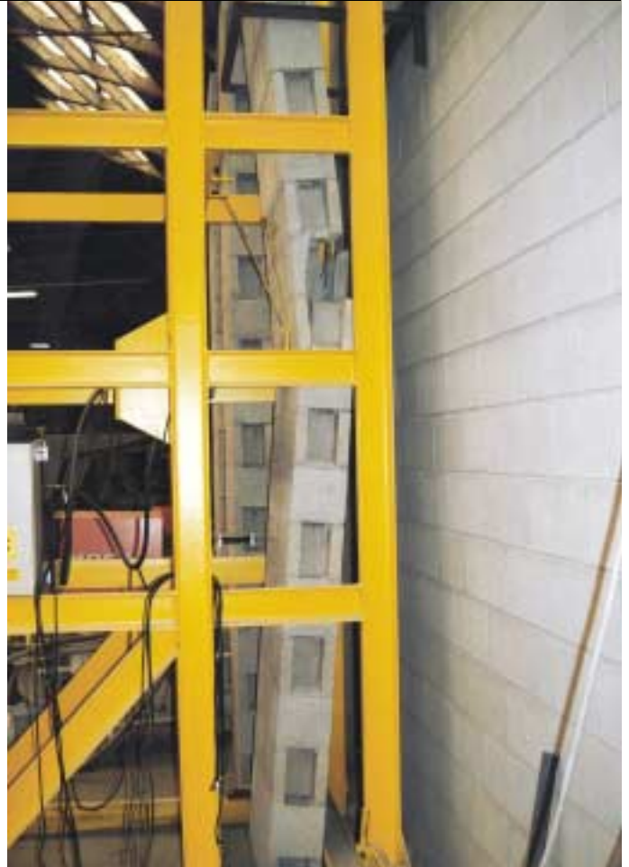
Fig.9 Prova a flessione di una serie di strutturazioni (laboratori Vibrapac)
