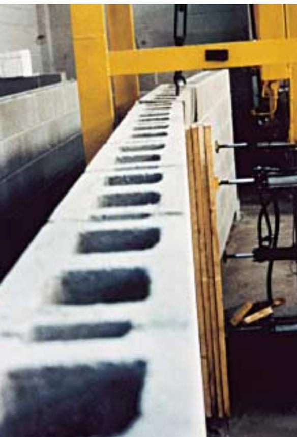
Fig. 3 Prove del concatenamento orizzontale delle mura-ture
