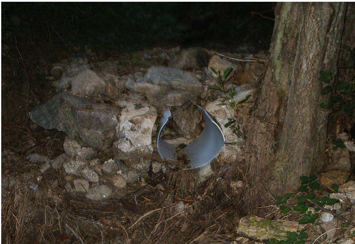
Foto 37 : Il tubo installato dai ricercatori non assolve più la sua funzione, serviva infatti per quantificare i deflussi.
