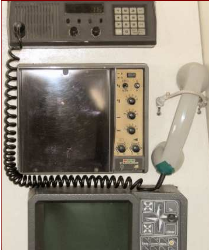
Figura 3 Dall'alto in basso: Radio VHF sul canale 16, echosondaggio, plotter
