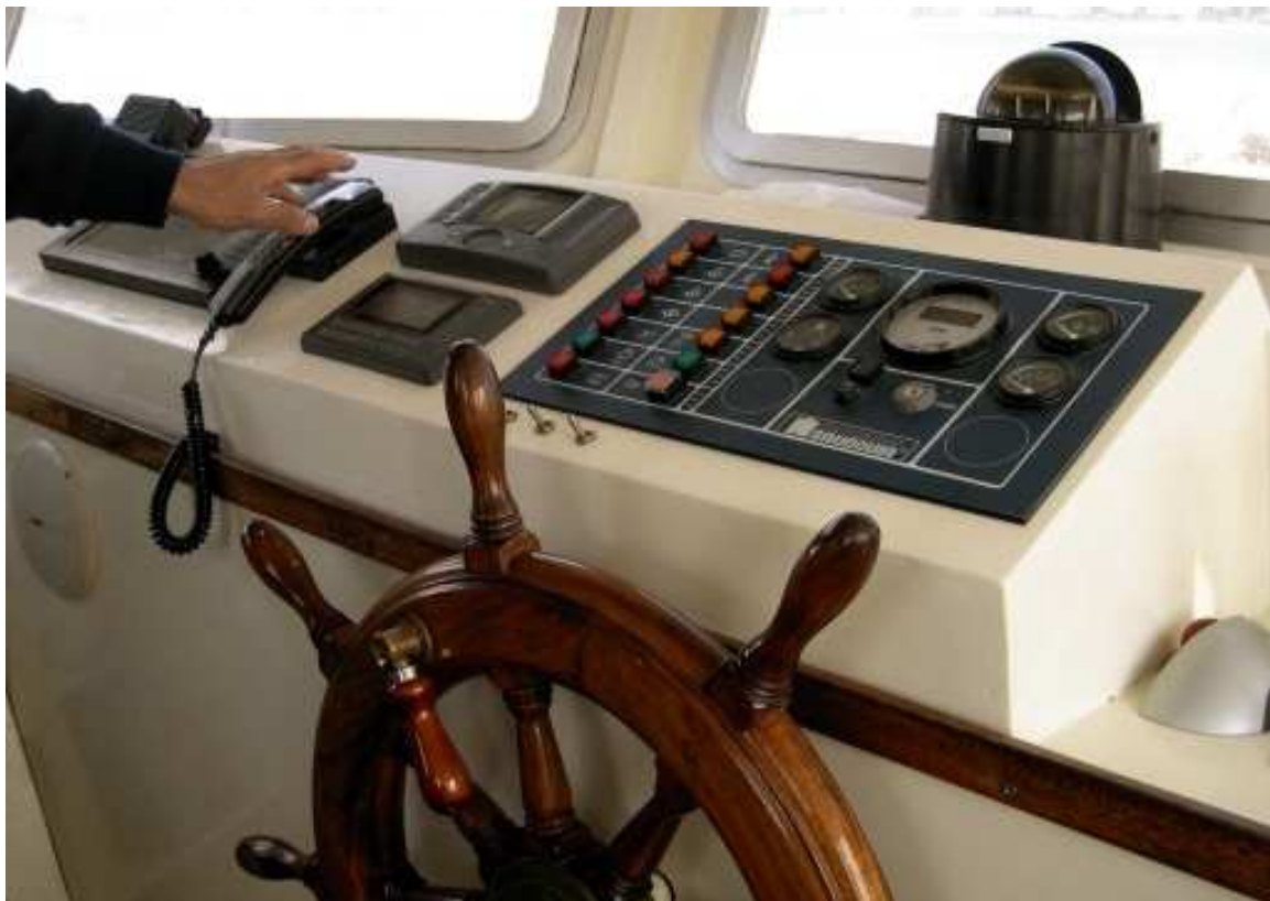
Figura 1- Particolari della cabina di comando: timone, pilota automatico, radar e bussola
