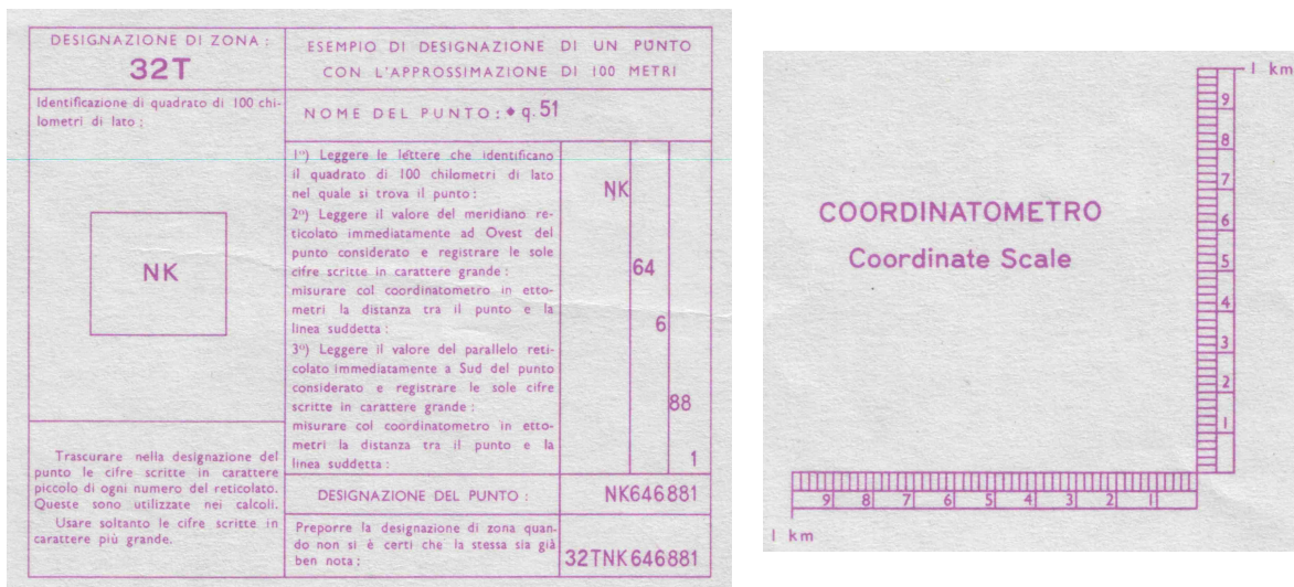
Fig. 3 - Determinazione delle coordinate gaussiane e coordinatometro.
