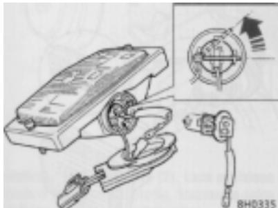
**Fendinebbia:** Svitare le viti per staccare la luce. Staccare la chiusura in gomma dalla base della luce e spostare il fermaglio della lampadina nella direzione della freccia in modo da staccare la lampadina.
