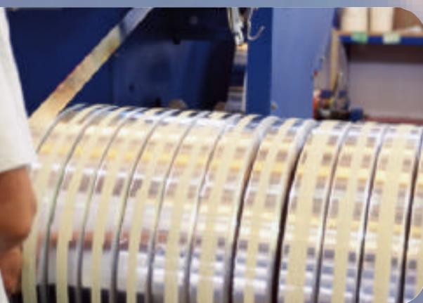
Avvolgimento eseguito con bobinatrice semiautomatica per bandella alluminio.
