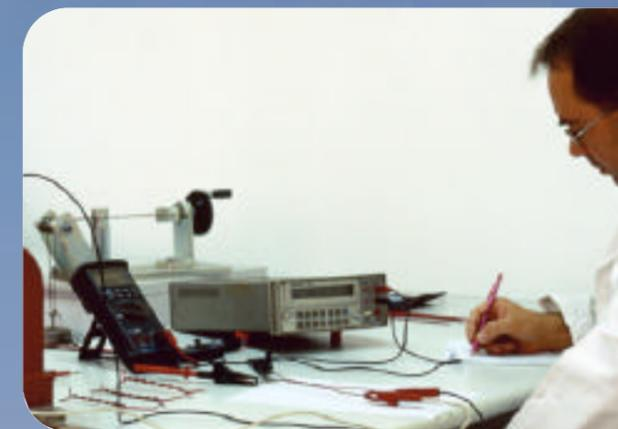
Controllo conduttori: Prova alla perforazione di isolamento secondo le norme IEC 851-1.
