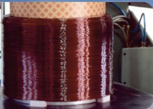
Avvolgimento eseguito con bobinatrice automatica a spire concentriche e strati verticali.
