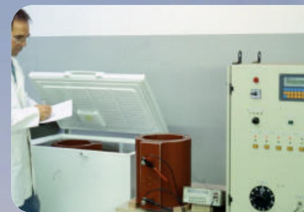
Prova di Shock Termico, secondo IEC 726. La prova consiste nel raffreddare la bobina a -25°C in 8 ore, e mantenere questa temperatura per altre 12 ore. Alimentarla quindi con una corrente di 2 volte la nominale e fino ad una sovratemperatura di 110°C senza che si verifichino criccate.
